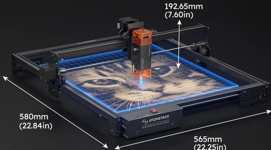
**Εξαιρετικά ελαφριά και ανθεκτική κατασκευή** - Η μηχανή χάραξης ζυγίζει μόλις 4,5 κιλά, το πλαίσιο είναι κατασκευασμένο εξ ολοκλήρου από ανθεκτικά αλουμινένια προφίλ. Η συναρμολόγηση όλων των εξαρτημάτων της μηχανής διαρκεί λιγότερο από 15 λεπτά.
